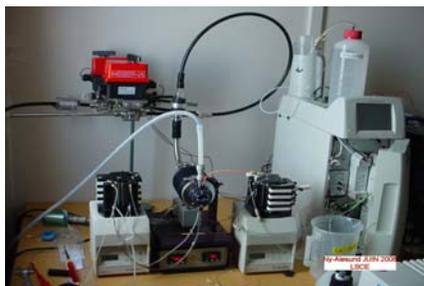
Figure3 Chaîne analytique développée au LSCE pour la mesure rapide des aérosols suivant deux classes de taille
